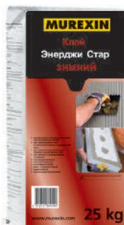
Универсальная армировочно-клеевая сухая смесь для устройства фасадных теплоизоляционных композиционных систем с наружными штукатурными слоями при отрицательных температурах до -10°C. Применяется для приклеивания плит из пенополистирола и минеральной ваты, устройства на их поверхности защитного базового штукатурного слоя, армированного фасадной щелочестойкой стеклосеткой, а также выравнивания (шпаклевания) оснований перед устройством декоративного финишного слоя.
